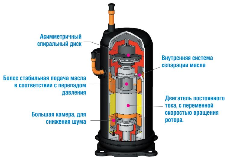
Охлаждение обмоток электродвигателя компрессора осуществляется фреоном, находящимся при высоком давлении. Конструкция спирального компрессора позволяет работать с большинством синтетических масел за счет применения внутреннего сепаратора масляной взвеси и конструкции трубы возврата масла. Система автоматики предотвращает повышение потребления энергии, возникающее при превышении давления конденсации, и обеспечивает эффективную и устойчивую работу.
